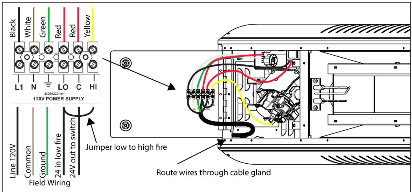
**A. LOW VOLTAGE (24V) ON / OFF SWITCH CONNECTION - SINGLE HEATERS**
